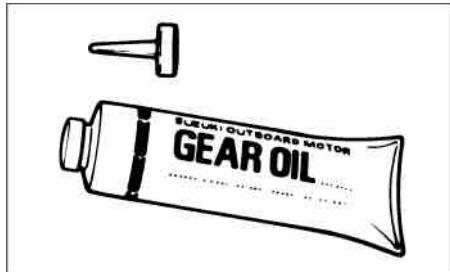
Izmantot Suzuki laivas motora transmisijas eļļu vai ekvivalentu augstas kvalitātes SAE90 hipoīda GL-5 pārnesumu transmisijas eļļu.
